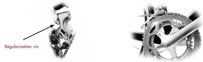
Le dérailleur ne doit pas dépasser la plus grande chaîne de roues de plus de 2 mm et ne doit pas toucher la pédale de manivelle. Pour un réglage correct de procéder comme suit.
