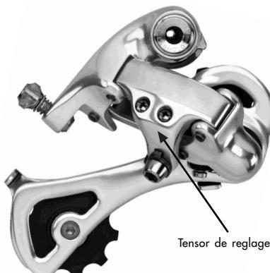
cerrar el tensor de reglage hasta que la cadena pase por el segundo piñón. (En el sentido de las agujas del reloj).
