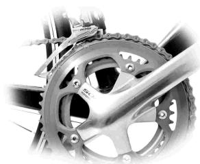
Tensar el bulón de ajuste hasta que no se oiga ningún ruido hasta que la cadena pase hasta el tercer piñón. (en el sentido de las agujas del reloj)
